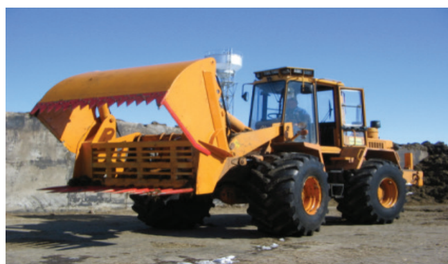
Рисунок 54. Агрегат для закладки на хранение и выгрузки кормов из хранилищ АЗВК 352С-02
