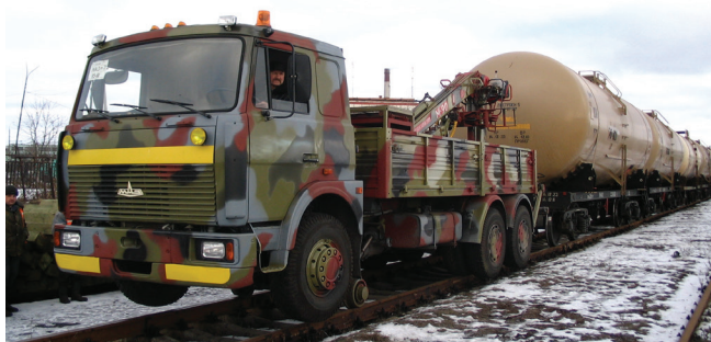
Рисунок 18. Многофункциональные транспортные средства на комбинированном ходу
