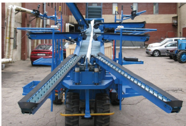
Рисунок 56. Агрегат самоходный универсальный с поточным контейнеровозом для сбора плодов и формирования кроны семечковых культур АСУ-6 (вид спереди)
