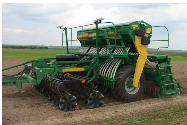
Рисунок 48. Агрегат почвообработывающе-посевной АПЛ-4
