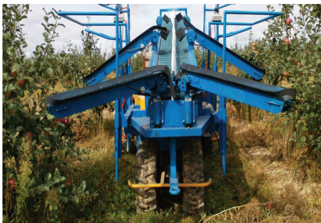
Рисунок 58. Агрегат самоходный универсальный с поточным контейнеровозом для сбора плодов и формирования кроны семечковых культур АСУ-6 (уборка плодов посредством агрегата)
