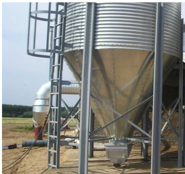
Рисунок 52. Комплект оборудования для раздачи сухих кормов ОРСК
