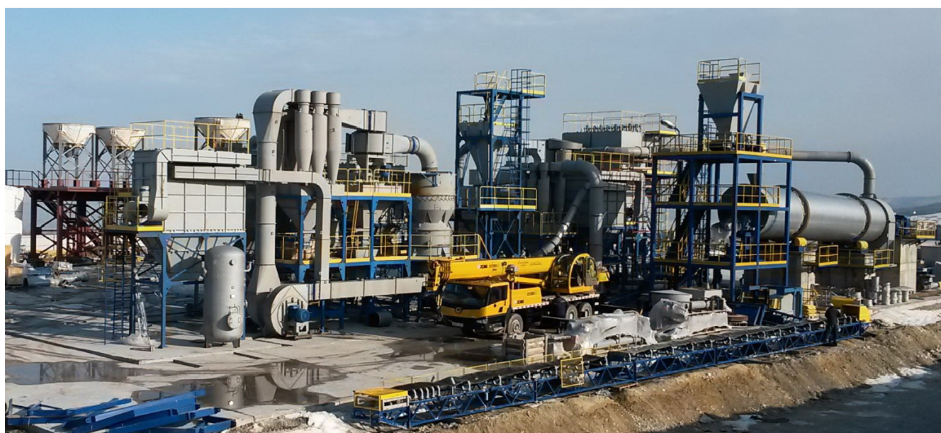
Рисунок 68,69. Сушильно-измельчительный комплекс минерального сырья
