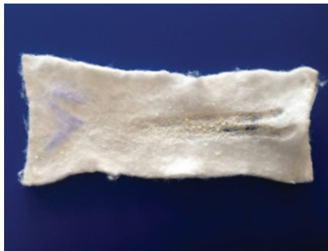
Рисунок 32. Образцы полиэфирной нетканого материала после огневого испытания (после ступенчатой огнезащитной обработки)
