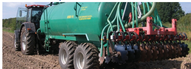
Рисунок 50. Машина для поверхностного и внутрипочвенного внесения жидкого навоза МПВУ-16
