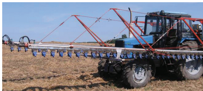
Рисунок 46. Распределитель штанговый минеральных удобрений РШУ-18 (вид спереди)
