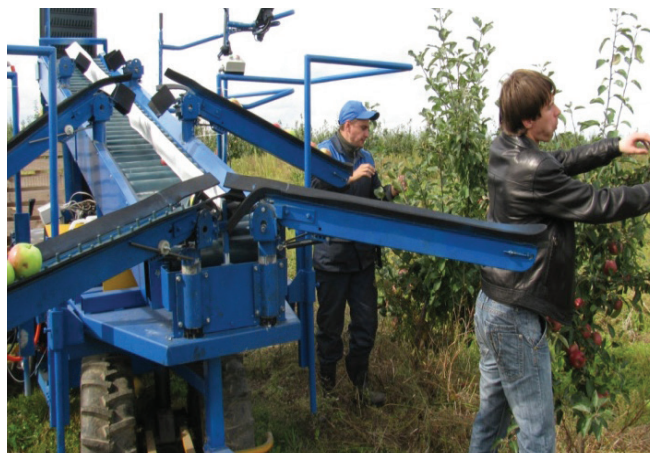
Рисунок 59. Агрегат самоходный универсальный с поточным контейнеровозом для сбора плодов и формирования кроны семечковых культур АСУ-6 (уборка плодов посредством агрегата)
