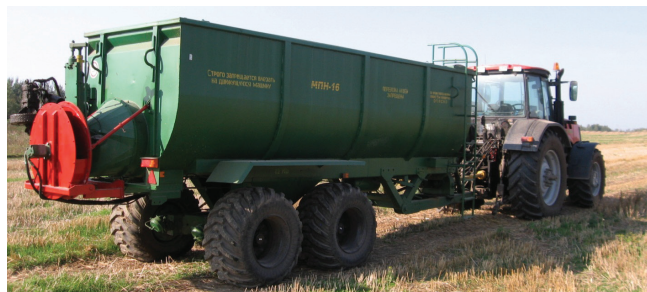
Рисунок 51. Машина для транспортирования и поверхностного внесения полужидкого навоза МПН-16
