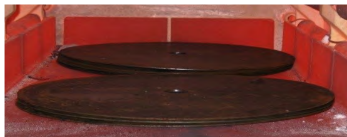
Фото 1 – Загрузка в нагревательную печь
