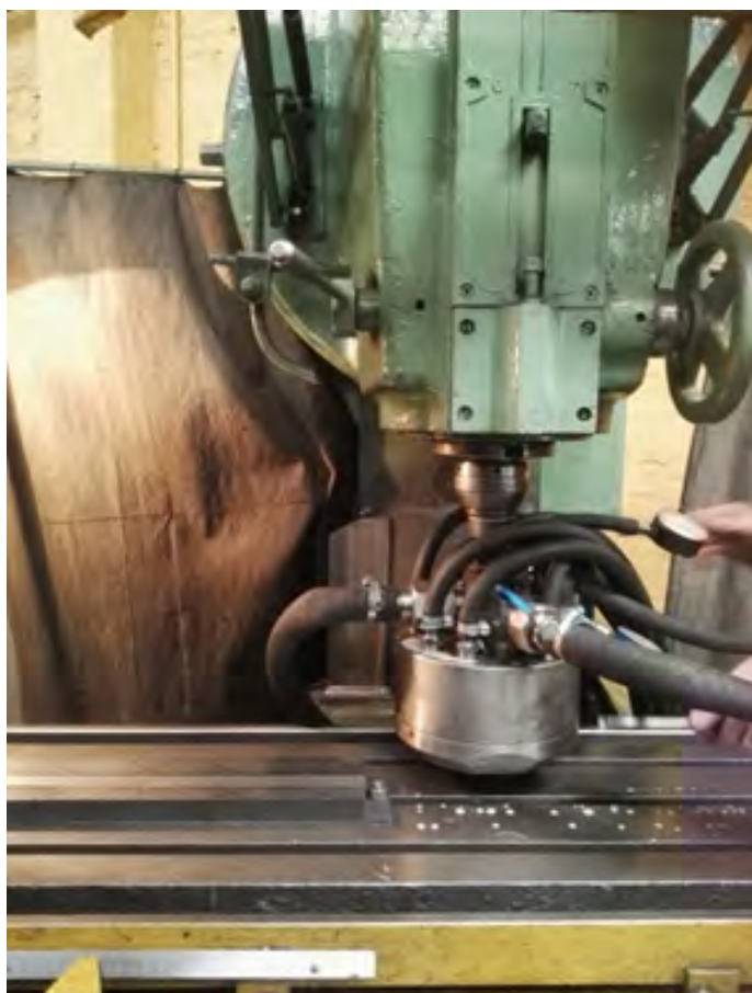
Рисунок 2 - Установка инструмента для ПВДО на фрезерном станке
