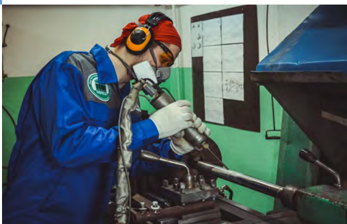
Рисунок 1 - ХОЛОДНОЕ ГАЗОДИНАМИЧЕСКОЕ НАПЫЛЕНИЕ наш суперсовременный способ сверхзвукового напыления без нагрева
