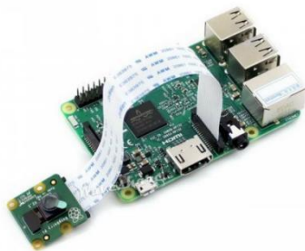
Рисунок 1 – Подключение модуля камеры к Raspberry Pi
