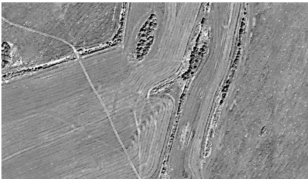
Рисунок 1 – Характерные полосы – технологические колеи, образующиеся в результате работы сельскохозяйственной техники.
