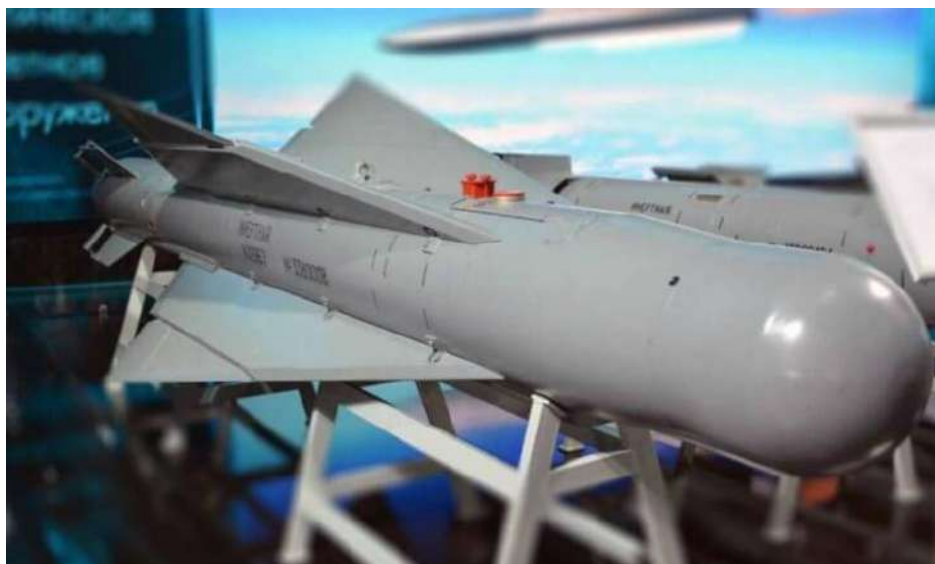
Рисунок 11.27 Управляемая планирующая авиационная бомба
